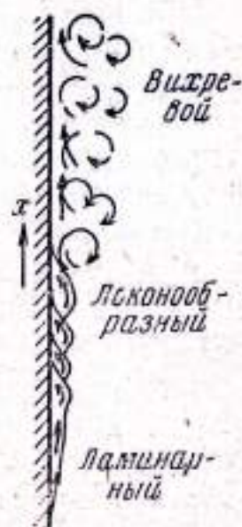
Рис. 13. Характер свободного движения воздуха вдоль нагретой вертикальной стенки
