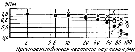
Рис. 25. ФПМ пленки Structurix D7 без свинцового экрана (1), со свинцовым экраном толщиной 30 мкм (2) и 120 мкм (3) при использовании рентгеновской трубки на 160 кэВ с мишенью из вольфрама
