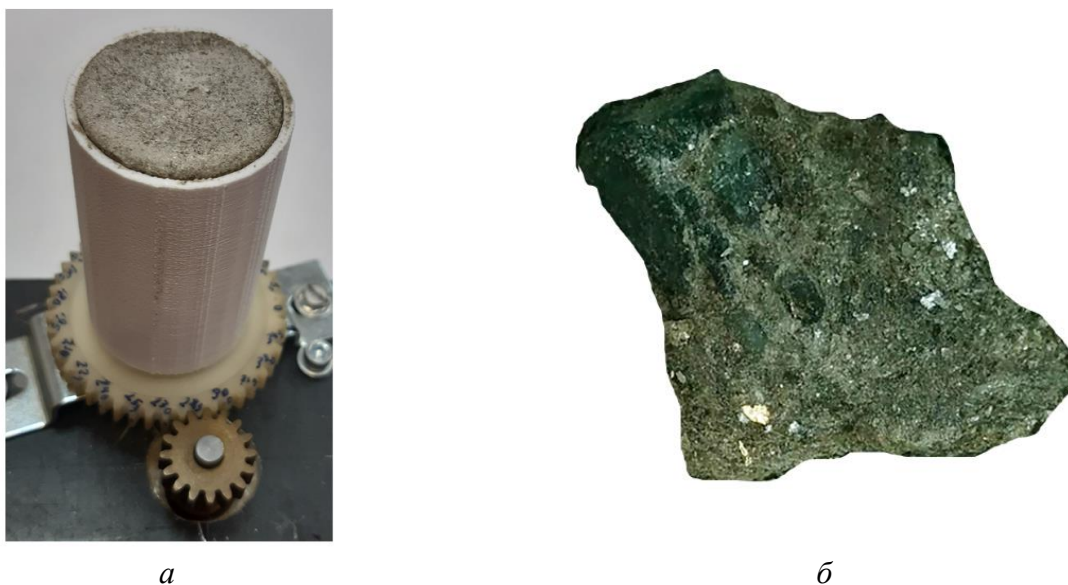
Рис. 1. Установленная на шаговый двигатель форма, в которую залит раствор слюдита (а); берилл, внедренный в слюдит (б), залитый в форму.
