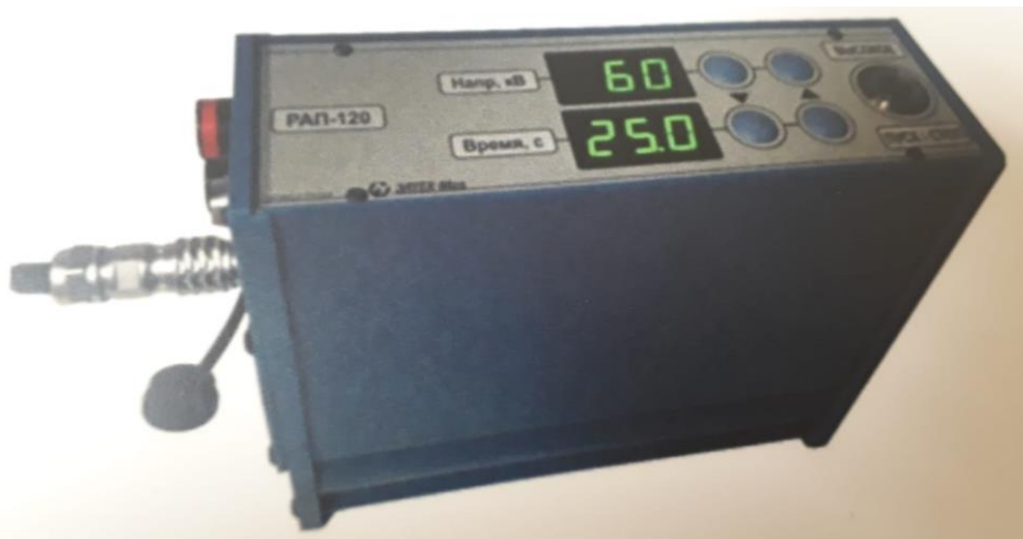
Рис. 1 Портативный рентгеновский аппарат РАП-120М-1Н (Ш).
