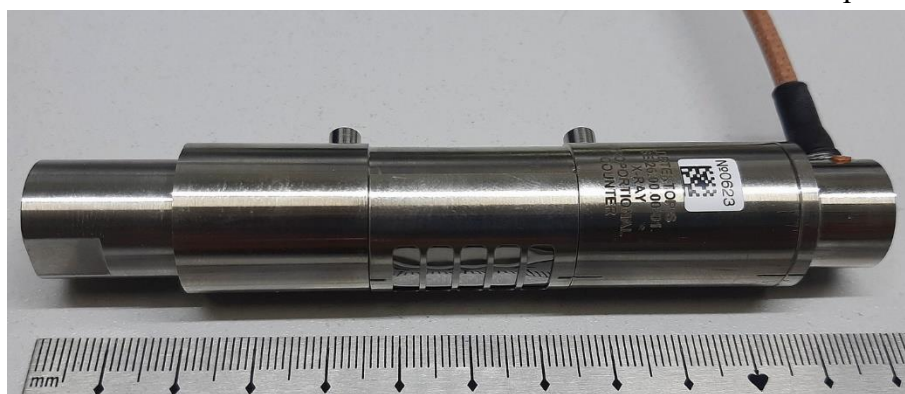
Рис. 4. Фотография газонаполненного детектора SE.26.00.00-01, собранного с использованием лазерной сварки.
