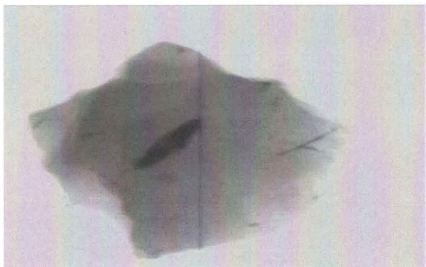
Рис. 2. Рентгенографическое изображение камня. Внутри камня частица с повышенным поглощением рентгеновского излучения.
