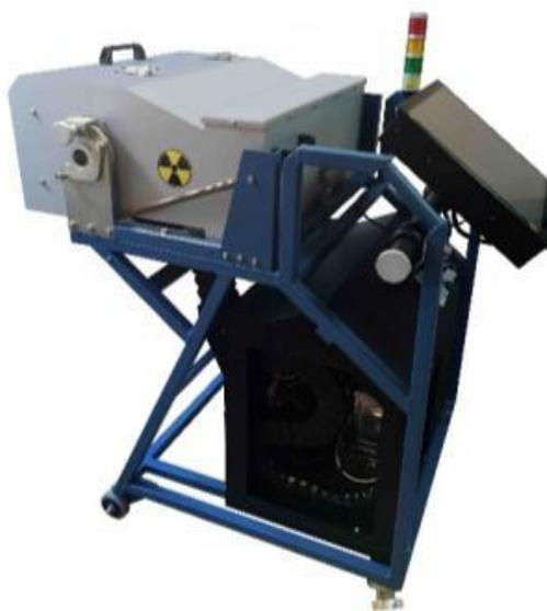
Рис. 18. Рентгеновская установка неразрушающего контроля полиэтиленовой оболочки, модель РУНК-50.
