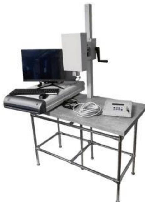
Рис. 7. Рентгенографический комплекс для судебно-медицинской экспертизы.
