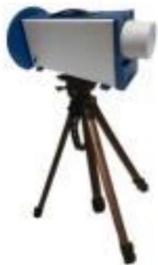
Рис. 6. Рентгенографический комплекс для реставрации.
