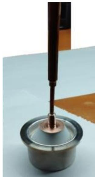
Рис. 1. Внешний вид образца ускорительной трубки на 1000 кВ.
