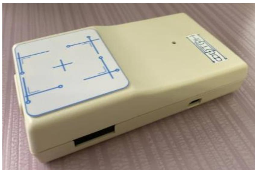
Рис. 1. Устройство контроля Фотон-1 (измерительный модуль).
