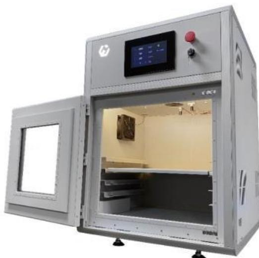
Рис. 17. Многофункциональная передвижная рентгеновская установка ПРДУ (исп. V).
