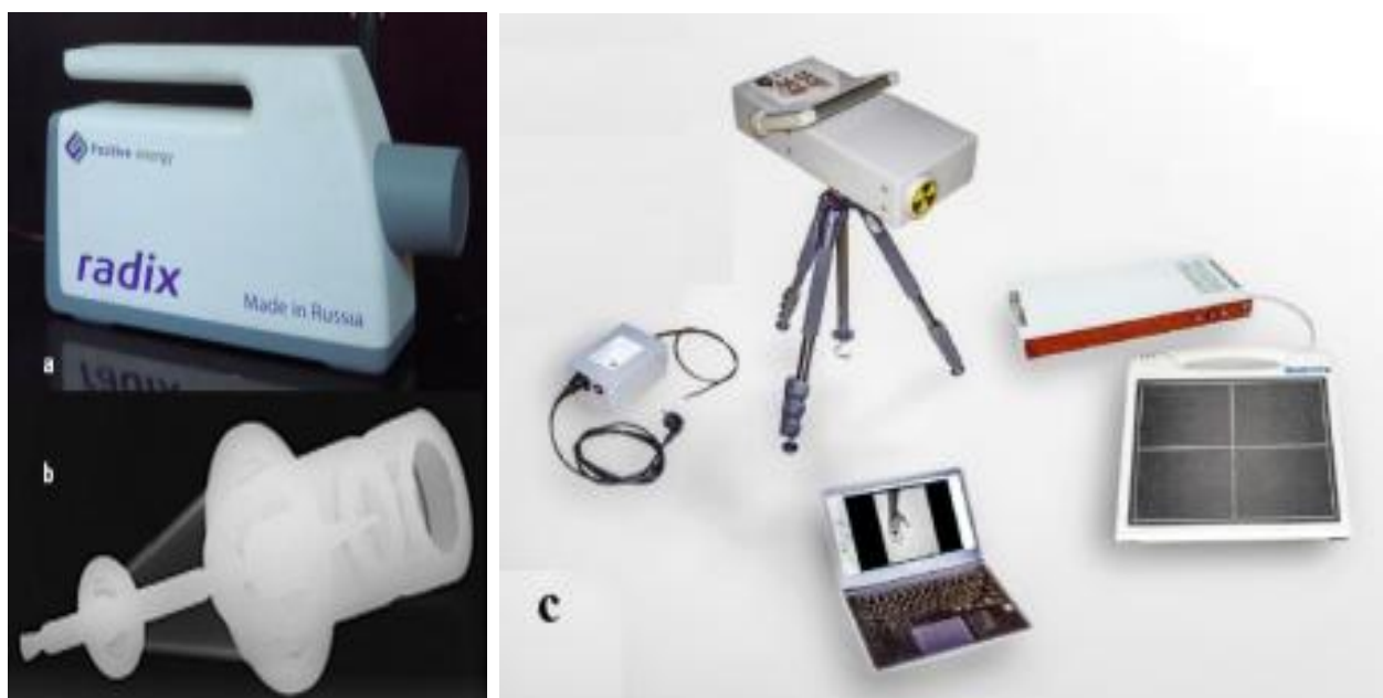
Рис. 4. Образцы опытных рентгеновских аппаратов (ООО «Позитивная энергия») (а, с), рентгенограмма рентгеновской трубки (б).
