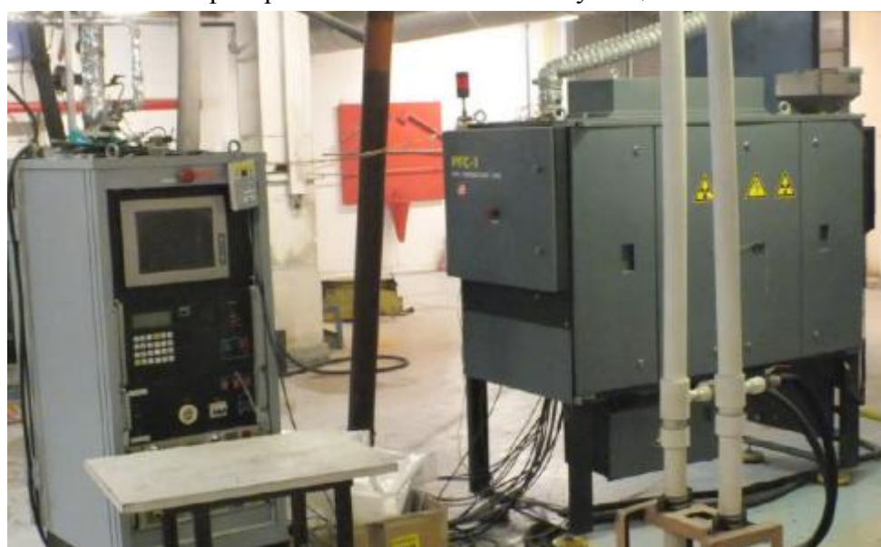
Рис. 3. Сепаратор РГС-1М используется на ОФ №16 для доводки концентрата РГС-2.
