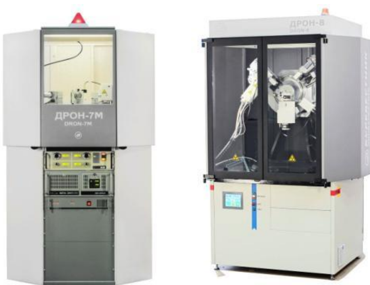
Рис. 1. Дифрактометры ДРОН-7М (а) и ДРОН-8 (б) в базовой комплектации Таблица 1. Этапы развития аппаратно-программного комплекса для рентгенодифракционных исследований в НПП «Буревестник».
