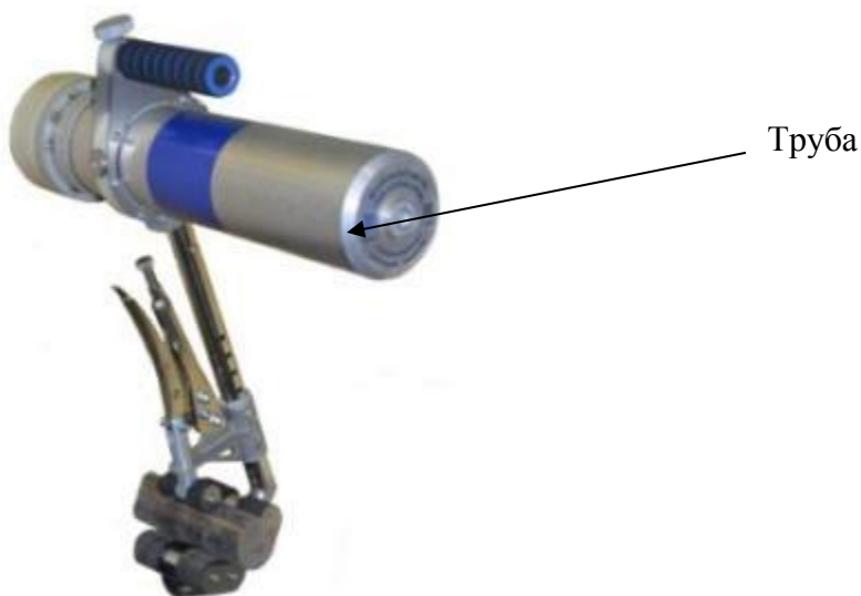
Рис. 3. Моноблок аппарата 0,3 СБК 160 С, установленный на трубе диаметром 50 мм с помощью специального оригинального устройства с зажимом.
