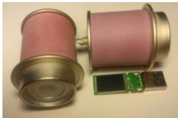
Рис. 4. Фото импульсных трубок типа ИРТД150 на напряжение 75-150 кВ. Диаметр керамической оболочки 30 мм.
