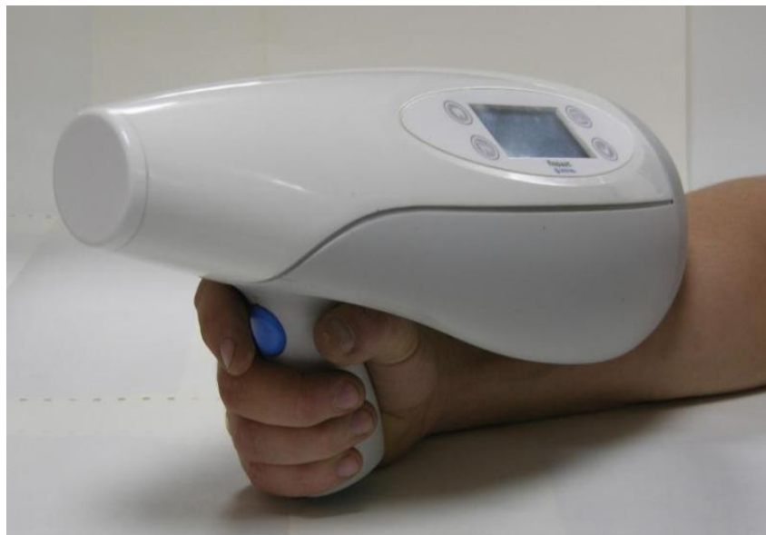
Рис. 1. Портативный рентгеновский аппарат семейства «ПАРДУС».
