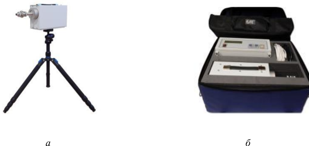
Рис. 4 Моноблок рентгеновского аппарата РАП-120ПМ на штативе (а) и полный комплект аппарата в транспортной сумке.
