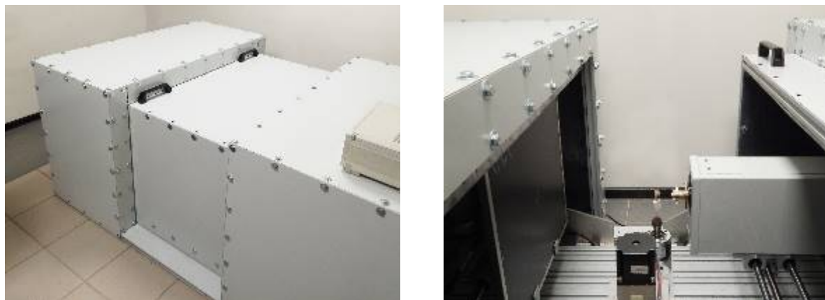
Рис. 1. Микрофокусный рентгеновский компьютерный томограф МРКТ-01:
