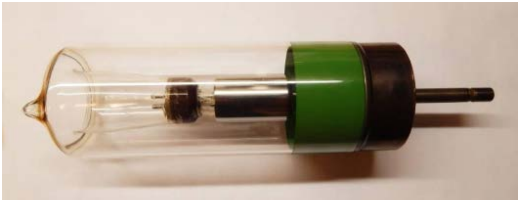
Рис. 2. Отпаянная рентгеновская трубка БС-16
