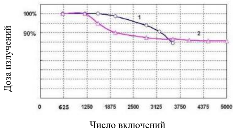
Рис.3 Зависимость дозы облучения от числа включений рентгеновской трубки для вольфрама с поликристаллической и монокристаллической структурой.
