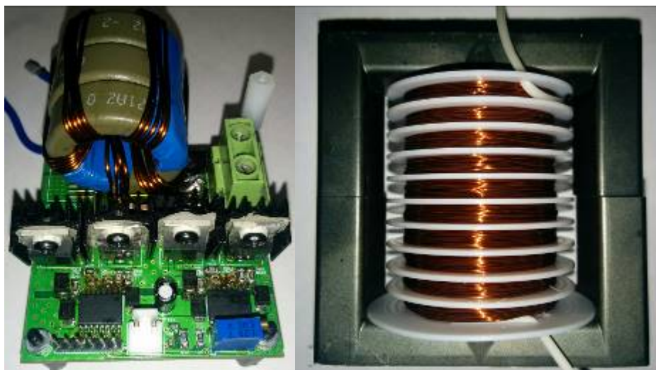
Рис. 3. Силовая плата резонансного преобразователя и модифицированная конструкция высоковольтного трансформатора
