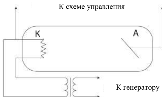
Рис.1. Использование накального трансформатора в рентгеновском аппарате.
