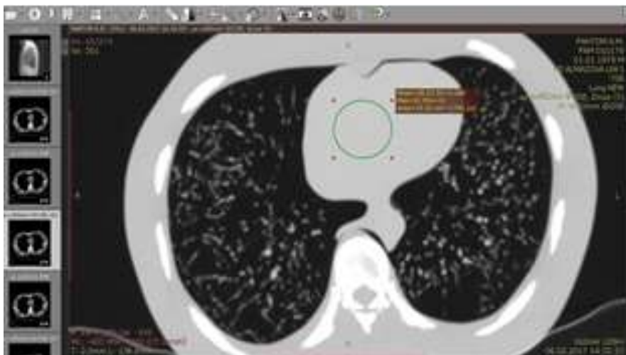
Рис. 1. Аксиальный срез КТ-изображения фантома и область интереса, для которой определяется уровень шума изображения (выделена зеленым).
