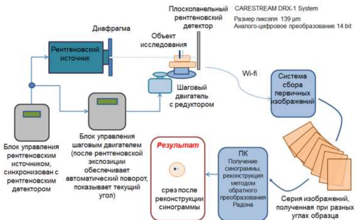
Рис. 3. Схема эксперимента по получению томографических срезов.
