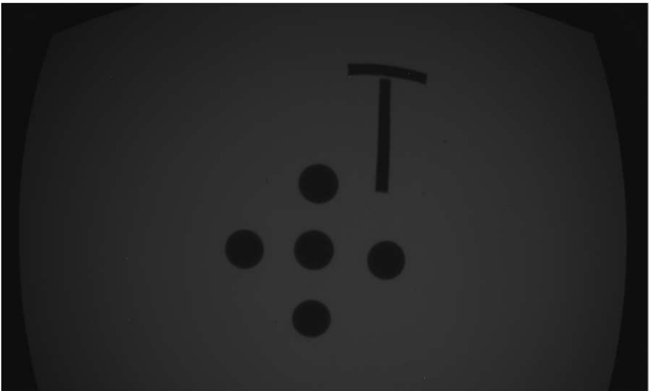
Рис.5. Цифровое рентгеновское изображение шарикового тест-объекта.
