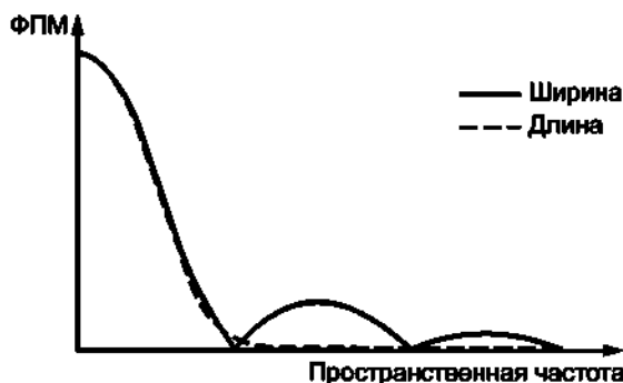
Рисунок С.3 — ФУНКЦИИ ПЕРЕДАЧИ МОДУЛЯЦИИ (ФПМ), соответствующие ФУНКЦИЯМ РАСШИРЕНИЯ ЛИНИИ (ФРЛ) на рисунке С.2
